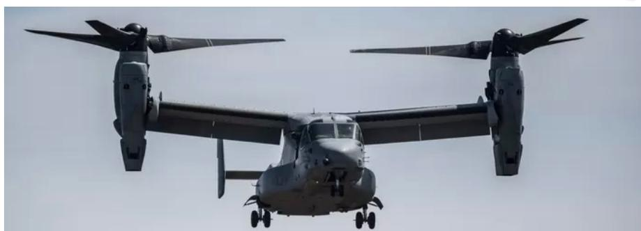
L'appareil est développé par Bell Hélicoptère et Boeing. Il combine les caractéristiques d'un hélicoptère et d'un avion. © AFP
